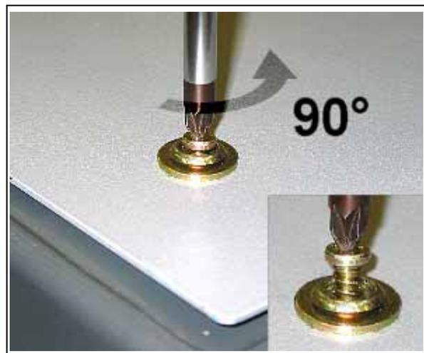
Fig. 5: Deckblech entfernen: Schrauben herausdrehen
