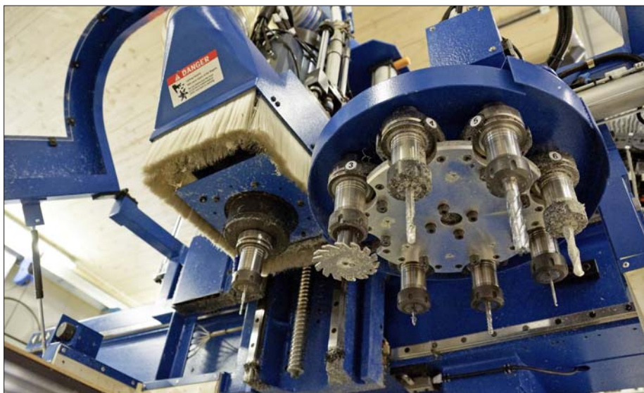
Blick von unten: Mitfahrender 8-fach-Werkzeug-Wechselkopf an der Portalfräsmaschine.
