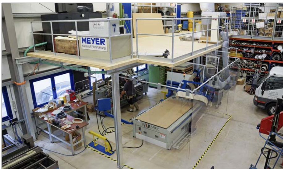
Die neue CNC-Fräsmaschine nimmt einen Ehrenplatz in der Produktionshalle des Kunststoffverarbeiters ein. Eine eigens darüber konstruierte Arbeitsbühne beherbergt weitere Technik und eine Eigenkonstruktion aus Plexiglas schützt Maschine und Mitarbeiter.
