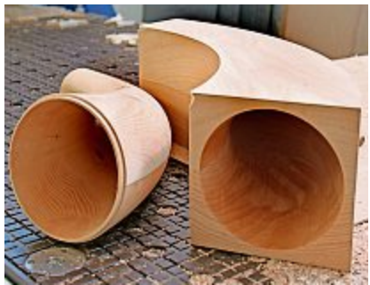
Rechts der grobe Zuschnitt und links das ausgefräste Instrumententeil.
